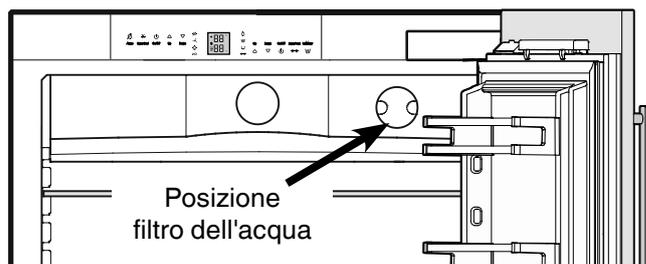
Quando sul display è visualizzato il simbolo a goccia, il filtro dell'acqua deve essere sostituito.
