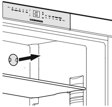
2. Inserire il filtro dell'acqua e girarlo di 90° in senso orario.
