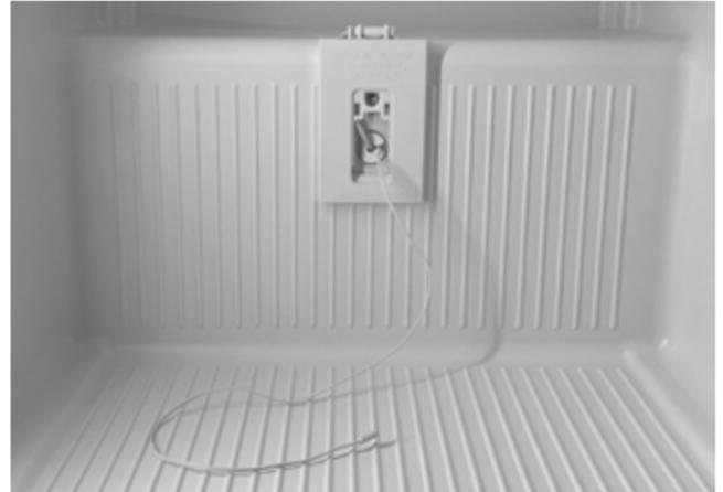
Equipement optionnel : passage de capteurs diamètre 38 mm pour qualification des appareils avec capteurs filaires.
