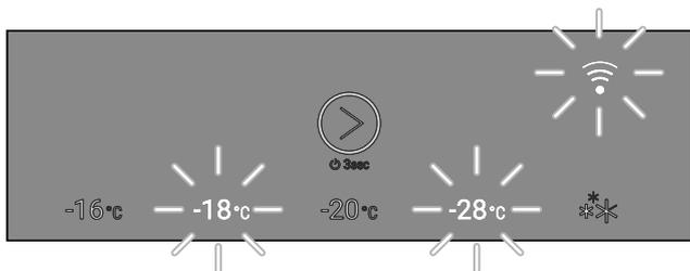
Fig. 41 Pantalla en caso de error de WLAN
