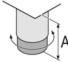
Fig. 14 Il piedino è regolabile da  $A = 115 \text{ mm}$  ( $4 \frac{1}{2} \text{ in}$ ) a  $175 \text{ mm}$  ( $6 \frac{7}{8} \text{ in}$ ).\*
