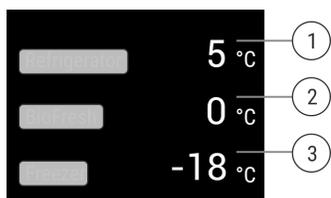
Fig. 6 L'affichage d'état indique la température réelle.
