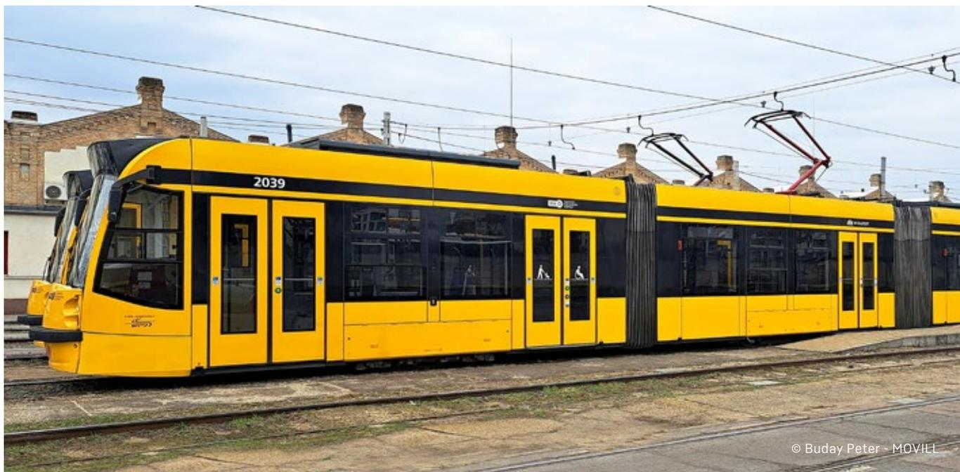
Tramway à plancher surbaissé Combino à Budapest, équipé de la technologie Liebherr.
