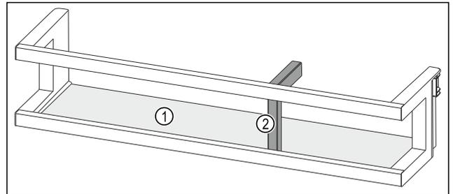
Fig. 74 Representación a modo de ejemplo del estante en la contrapuerta con soporte para botellas
