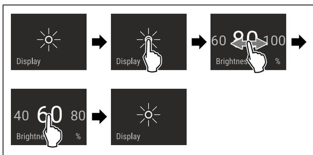
Fig. 44 Representación a modo de ejemplo: Cambiar de 80 % a 60 %.
