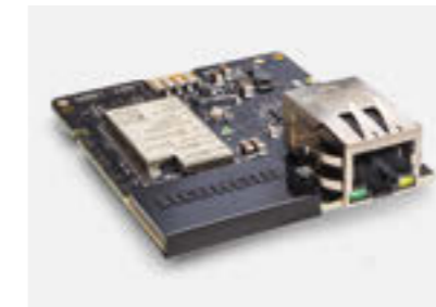
SmartModule (6145269) Το SmartModule συνδέει συσκευές Liebherr από τη σειρά Performance με το SmartMonitoring ή τα υπάρχοντα συστήματα παρακολούθησης. Η μικρή μονάδα με ενσωματωμένο LAN/WiFi είναι έτοιμη για χρήση, αμέσως μετά την τοποθέτησή της στο πίσω μέρος της συσκευής.
