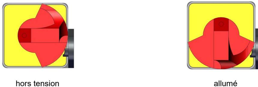
Figure 8: Interrupteur principal (4) situé au côté droit de l'appareil
