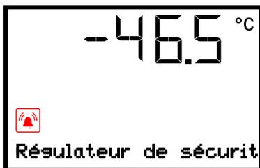
Indication d'alarme (exemple : alarme du régulateur de sécurité)
