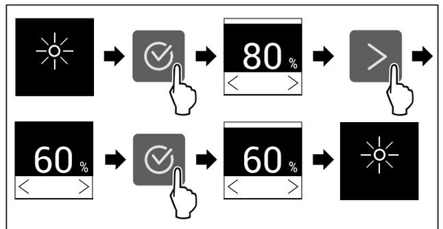
Fig. 41 Beispielhafte Darstellung: Von 80 % zu 60 % wechseln.
