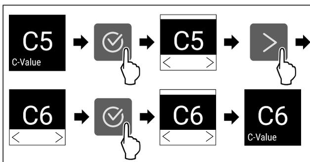
Fig. 25 Beispielhafte Darstellung: Von C5 zu C6 wechseln.
