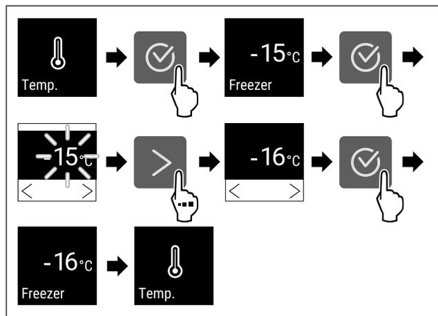
Fig. 59 Temperaturwechsel von -15 °C auf -16 °C
