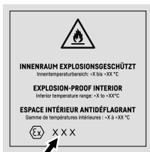
Fig. 3 Kapslingsklasse: II 3/-G Ex ec IIC T6 Gc/-
