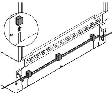
Monter les supports de câble à l'arrière de l'appareil. Placer le câble d'alimentation/la conduite d'eau dans les supports de câble. Introduire l'appareil dans la niche.
