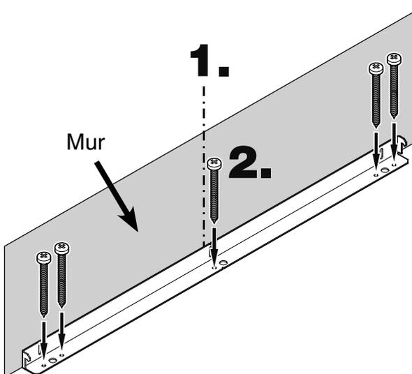
Si l'appareil est placé entre deux meubles d'une profondeur excédant 620 mm, l'appareil n'est alors plus en contact avec l'équerre anti-basculement.
