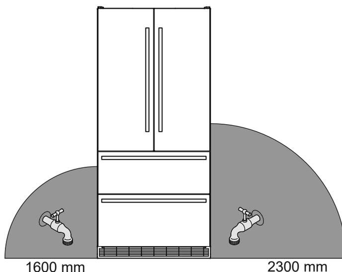
Le robinet d'arrêt d'eau doit se trouver à l'intérieur de la surface marquée en gris.
