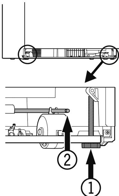
2. Tourner les barres d'ajustage (2) dans le sens des aiguilles d'une montre jusqu'à ce que la plaque de montage du compresseur soit en contact avec l'équerre anti-basculement.
