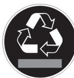
Dieser oder ein ähnlicher Aufkleber kann sich auf der Rückseite des Gerätes befinden. Er verweist darauf, dass sich in der Tür und/oder im Gehäuse Vakuuminisierpaneele (VIP) oder Perlitpaneele befinden. Dieser Hinweis ist nur für das Recycling bedeutsam. Den Aufkleber nicht entfernen.
