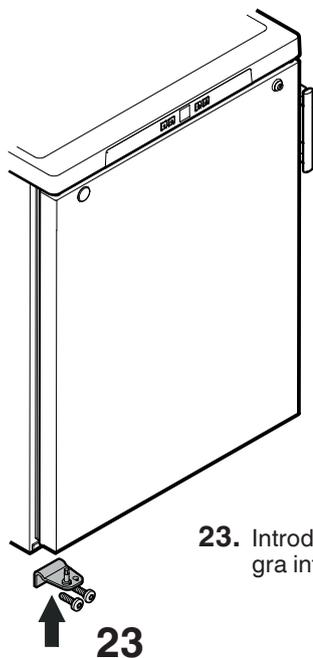
23. Introducir el soporte angular en la bisagra inferior de la puerta y atornillarlo.
