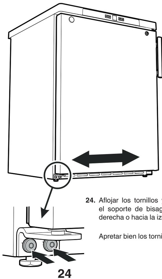
24. Aflojar los tornillos y desplazar el soporte de bisagra hacia la derecha o hacia la izquierda.
