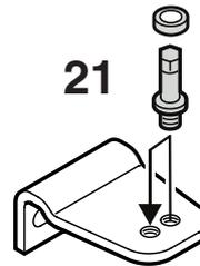
21. Cambiar el eje del soporte angular al lado opuesto.
