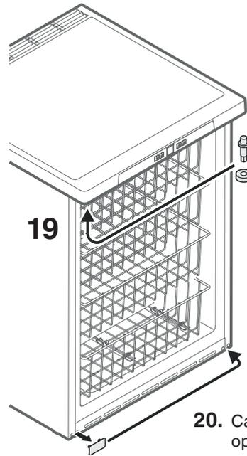
19. Cambiar el eje de arriba al lado opuesto del aparato.
