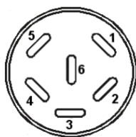
Slika 20: Dodelitev nožic vtičnice (10) za možnost analognega izhoda
