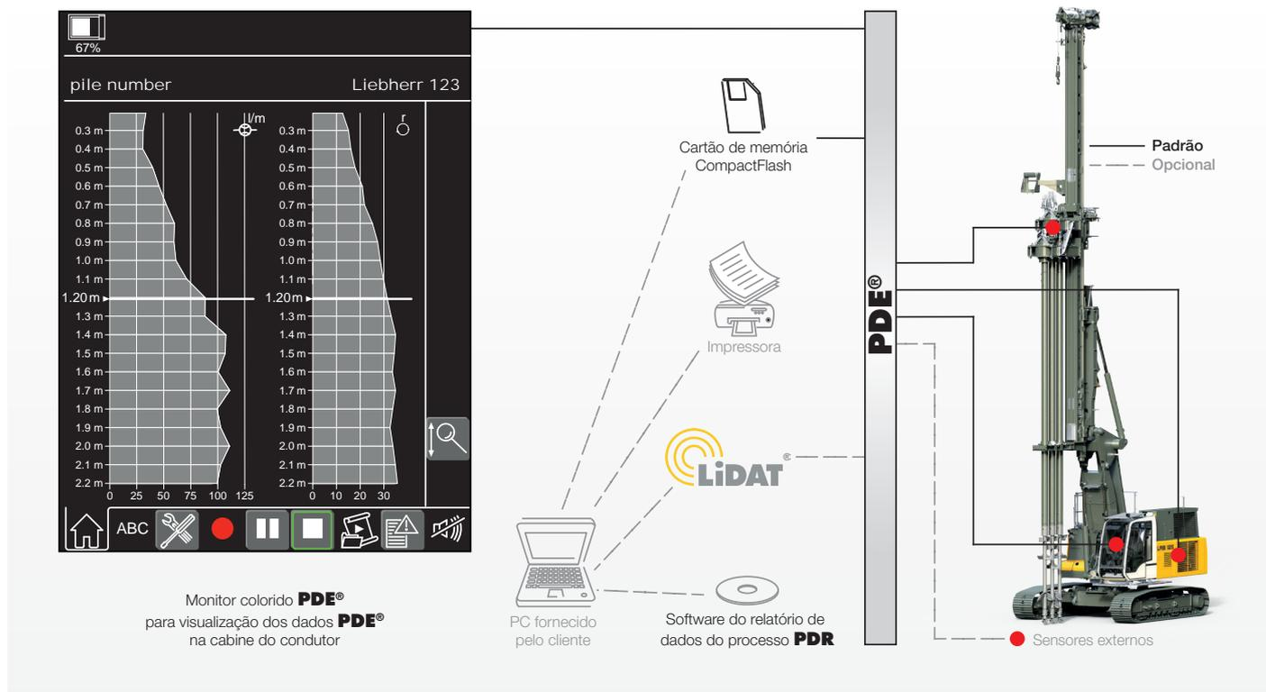
Dependendo da aplicação, os dados gravados e processados são exibidos na tela sensível ao toque PDE®, na cabine do operador, por exemplo, na forma de uma estaca moldada-in-loco.
