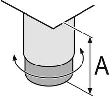
Fig. 10 Der Stellfuß ist von  $A = 115 \text{ mm}$  (4 1/2 in) bis  $175 \text{ mm}$  (6 7/8 in) verstellbar.
