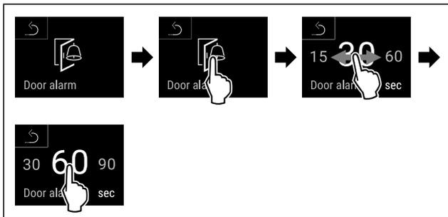
Fig. 77 Beispielhafte Darstellung: Türalarm von 30 Sekunden zu 60 Sekunden wechseln.
