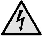
Das Symbol befindet sich auf der Geräte-rückseite im Bereich des Alarmrelais und weist auf folgende Gefahr hin: **Elektrischer Schlag!** Auch bei einem vom Netz getrennten Gerät kann noch Fremdspannung anliegen. Aufkleber nicht entfernen.
