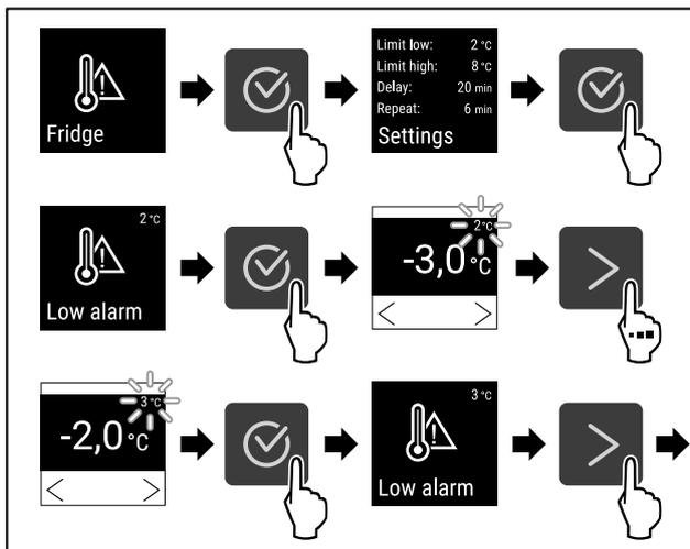
Fig. 140 Beispiel für die Einstellung der Temperaturergrenze, basierend auf einer eingestellten Gerätetemperatur von 5 °C.
