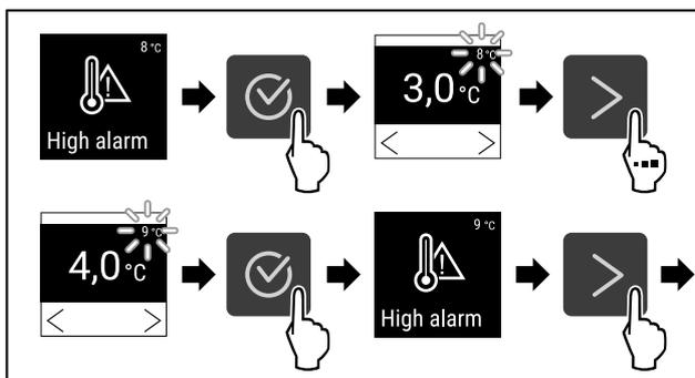
Fig. 141 Beispiel für die Einstellung der Temperaturergrenze, basierend auf einer eingestellten Gerätetemperatur von 5 °C.
