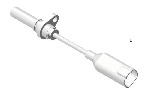
**Technische Daten** 8-32V Nennspannung U Kurzschlussfestigkeit Ja Stromverbrauch <20mA bei 24V Verpolungsschutz Ja bis maximal 32V Schutzart ISO 20635 Kabelbaumlänge IP6K9K 887 mm Sensorseite Steckerseite (verbunden) IP67 maximaler Druck auf aktive Frequenzbereich - 0 bis 20kHz 10bar Fläche Steckanschluss E Deutsch DT04-4P Luftspalt minimal/maximal 0.3/2.0mm Stromstärke<sub>max.</sub> 40mA
