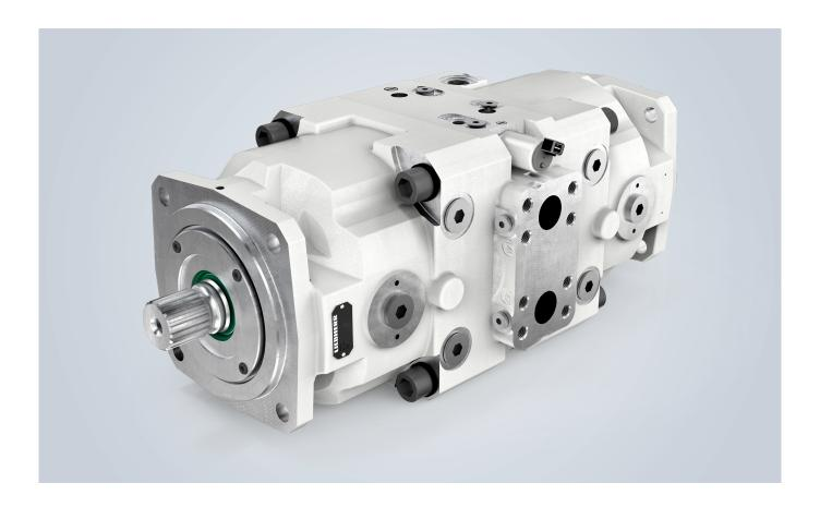
Die Liebherr-Axialkolbendoppelmotoren der Baureihe DMVA sind in Schrägscheibenbauweise für den offenen und geschlossenen Kreislauf konzipiert und wurden speziell für den Einsatz in mobilen Arbeitsmaschinen unter rauen Umgebungsbedingungen entwickelt.
