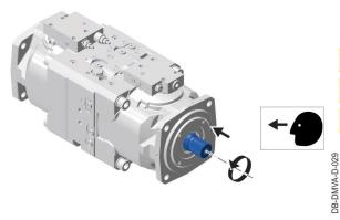
Die Drehrichtung wird mit Blick auf die Triebwelle angegeben, wie im Bild dargestellt.
