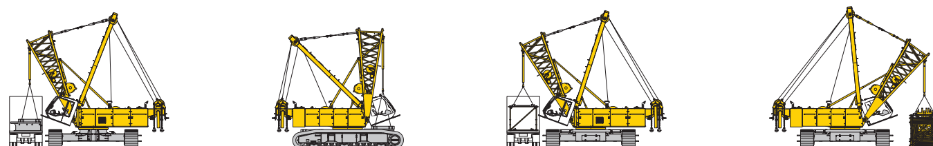
Déchargement et montage du contrepoids central
