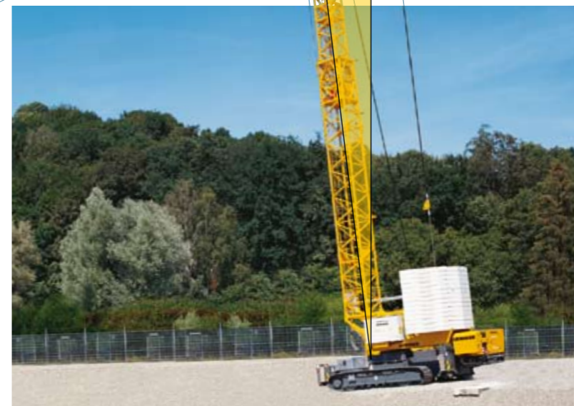
... y hasta 10% inclinación longitudinal no representan problema alguno para las grúas sobre cadenas de Liebherr.
