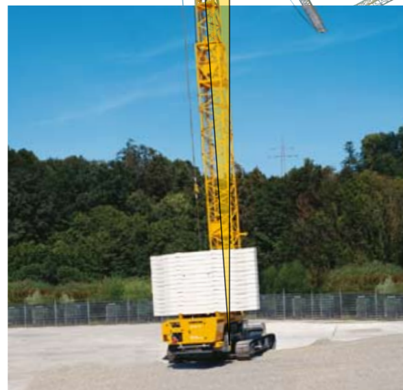
Todoterreno: Inclinación lateral de hasta 7%...
