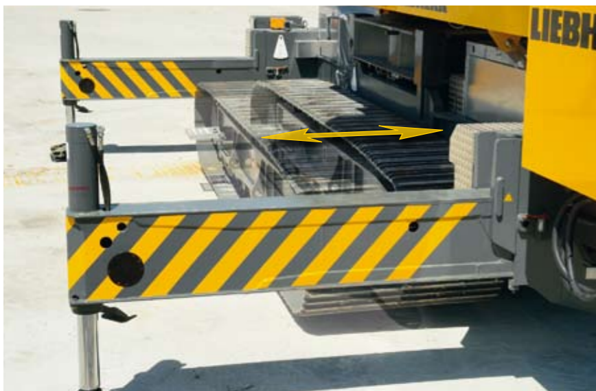
Orientado hacia la práctica: Base de apoyo adaptable en la traslación en obras gracias a las orugas desplazables.
