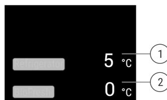
Fig. 9 L'indicatore di stato mostra la temperatura reale.\*
