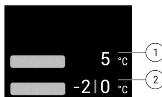
Fig. 8 L'indicatore di stato mostra la temperatura reale.\*
