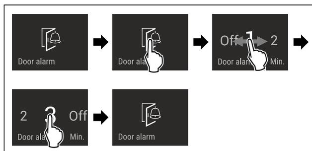
Fig. 52 Immagine a titolo di esempio: Modificare l'allarme della porta da 1 minuto a 3 minuti.
