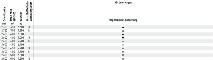
Ausführungsstufe I: Für verschleißarmes Material (z.B. Kalkstein ohne Feuerstein-Einschlüsse)
