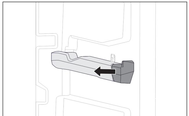
Fig. 117 Élément emboîtable sur la nervure de récipient droite
