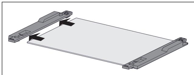
Fig. 112 Tablette en verre avec pièces de retenue
