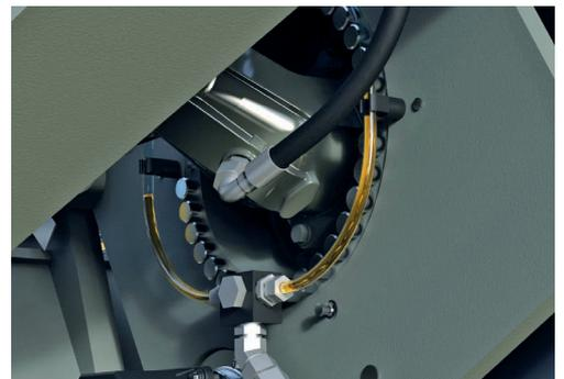
Tuyau de niveau d'huile pour le treuil de relevage flèche
