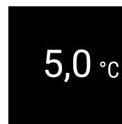
Fig. 64 Ένδειξη κατάστασης με πραγματική θερμοκρασία
