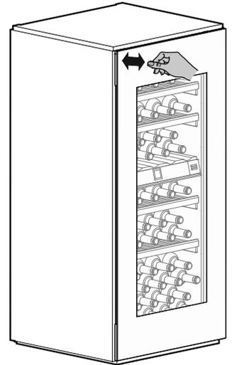
Die Tür wird durch die Schubstange ca. 7 cm geöffnet.
