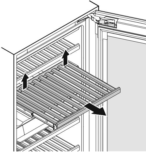
Das Holzbord hinten rechts und links nach oben ziehen (ausrasten) und nach vorne entnehmen.
