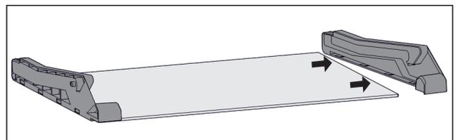
Fig. 80 Glasplatte mit Seitenteilen
