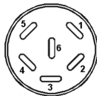
图20：用于模拟输出端子选购件的插座(10)的引脚连接
