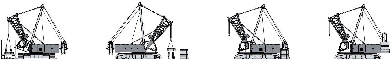
Entladung, Zusammen- und Anbau des Heckballastes
