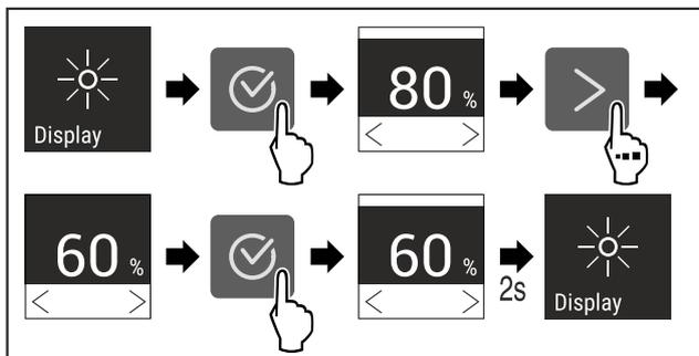
Fig. 84 Representación a modo de ejemplo: Cambiar de 80 % a 60 %.
