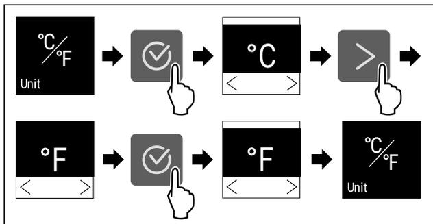
Fig. 82 Representación a modo de ejemplo: Cambiar de grados Celsius a Fahrenheit.
