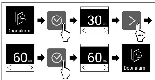
Fig. 112 Representación a modo de ejemplo: Cambiar alarma de puerta de 30 segundos a 60 segundos.
