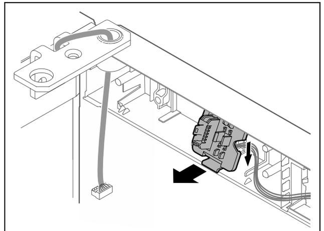
Fig. 20 La posición de montaje del soporte del conector puede estar girada 180°.
