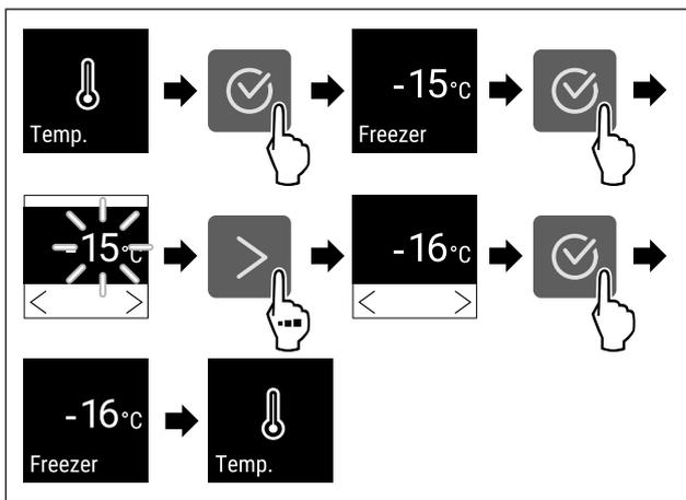
Fig. 65 Cambio de temperatura de -15 °C a -16 °C
