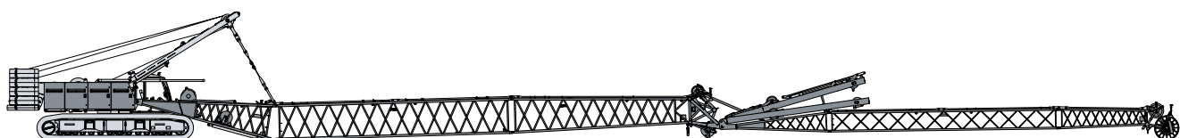
Anbau des Auslegers
