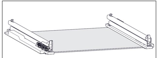
Fig. 114 Dämpfungseinheit
