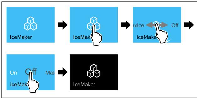
Fig. 43 Beispielhafte Darstellung mit aktiver Funktion IceMaker
