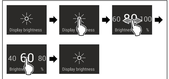
Fig. 55 Beispielhafte Darstellung: Von 80 % zu 60 % wechseln.
