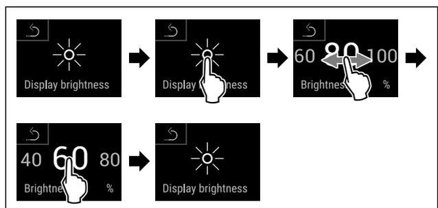
Fig. 134 Beispielhafte Darstellung: Von 80 % zu 60 % wechseln.
