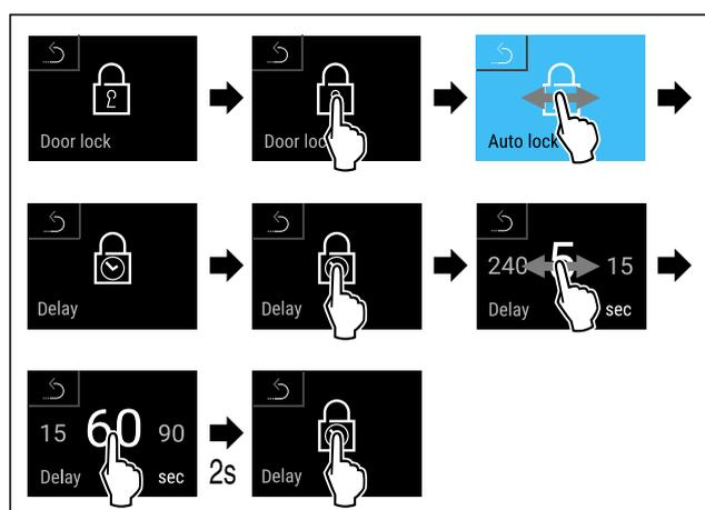
Fig. 93 Folgende Werte sind einstellbar: 5, 15, 60, 90, 120, 180 und 240 Sekunden
