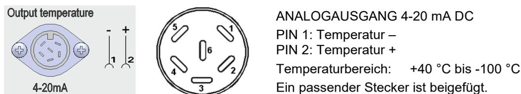
Abb. 20: Pinbelegung der Buchse (10) für Option Analogausgang
