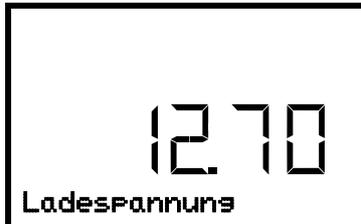
Anzeige der aktuellen Ladespannung der Batterie.
