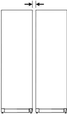
Fig. 10 Side-by-Side-Aufstellung
