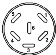
Рисунок 20: Назначение контактов в разъеме (10) опционального аналогового выхода
