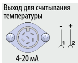
Рисунок 20: Назначение контактов в разъеме (10) опционального аналогового выхода
