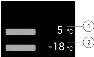
Fig. 6 Az állapotjelző a tényleges hőmérsékletet mutatja. (1) Hűtőrész hőmérséklet-kijelzője (2) Fagyasztórész hőmérséklet-kijelzője
