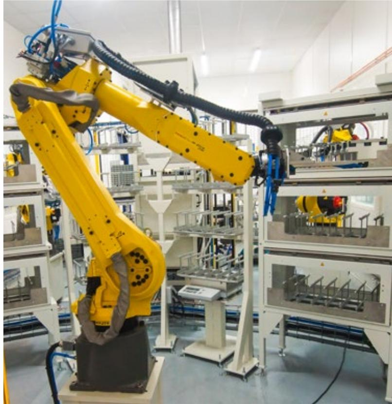
Chez Liebherr-Aerospace Toulouse, quatre robots au total interviennent dans la fabrication d'échangeurs thermiques. Le robot chargé de la manutention amène les tôles pièce par pièce.
