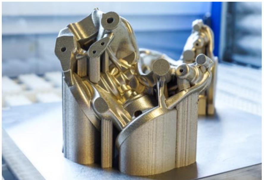
Corps de vanne semi-fini produit à Toulouse, avant élimination des supports de production.
