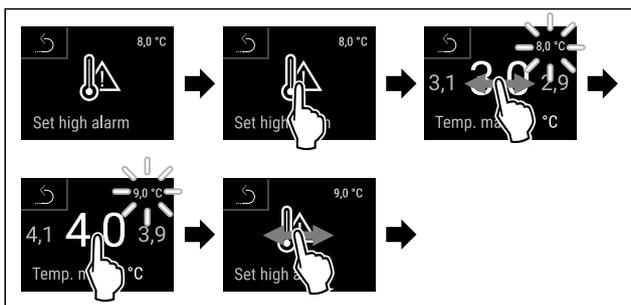
Fig. 211 Esempio di regolazione del limite superiore di temperatura, sulla base della temperatura impostata dell'apparecchio di 5 °C.
