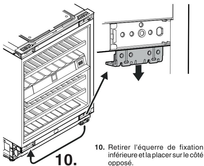
10. Retirer l'équerre de fixation inférieure et la placer sur le côté opposé.
