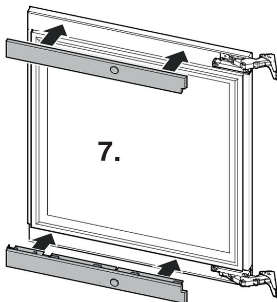
7. Mettre les caches en place et les enclipser.
