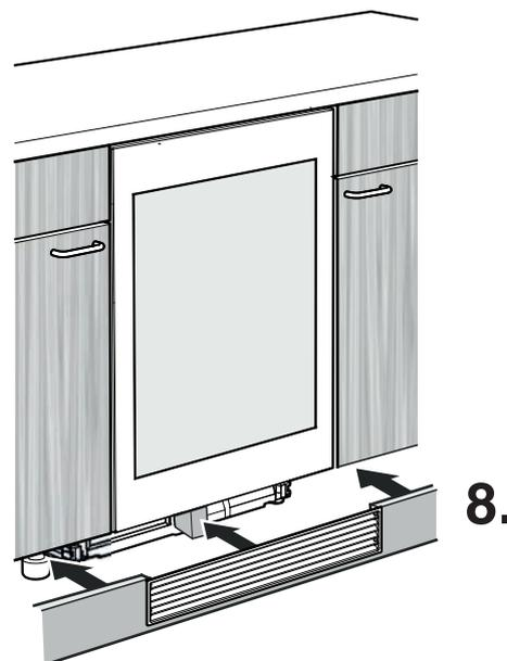
8. Mettre la plinthe en place. Ce faisant, la pièce moulée en mousse est repoussée vers l'arrière dans sa position définitive.
