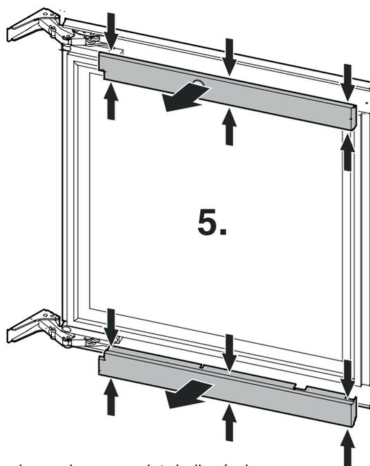
5. Appuyer sur les caches aux points indiqués, les déclipser et les retirer.
