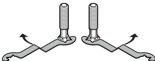
Tourner la clé dans le sens horaire pour soulever l'avant de l'appareil et la tourner dans le sens anti-horaire pour l'abaisser.
