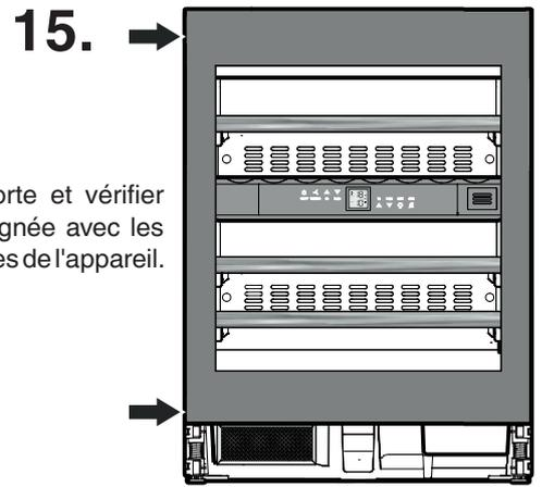
15. Fermer la porte et vérifier si elle est alignée avec les parois latérales de l'appareil.
