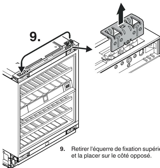
9. Retirer l'équerre de fixation supérieure et la placer sur le côté opposé.
