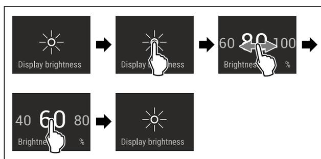
Fig. 48 Beispielhafte Darstellung: Von 80 % zu 60 % wechseln.
