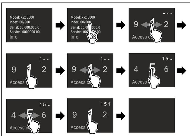
Fig. 5 Beispielhafte Darstellung, Zugang mit Zahlencode **151**
