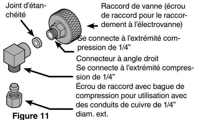
Le raccordement du raccord de vanne peut être réalisé avec ou sans le connecteur à angle droit, selon le besoin. Les tuyaux de fabrique à glaçons de type tressé peuvent être connectés directement aux extrémités fileté. Pour le raccordement à des conduits de cuivre de 1/4\" diam. ext., utiliser l'écrou de raccord et la bague de compression.
