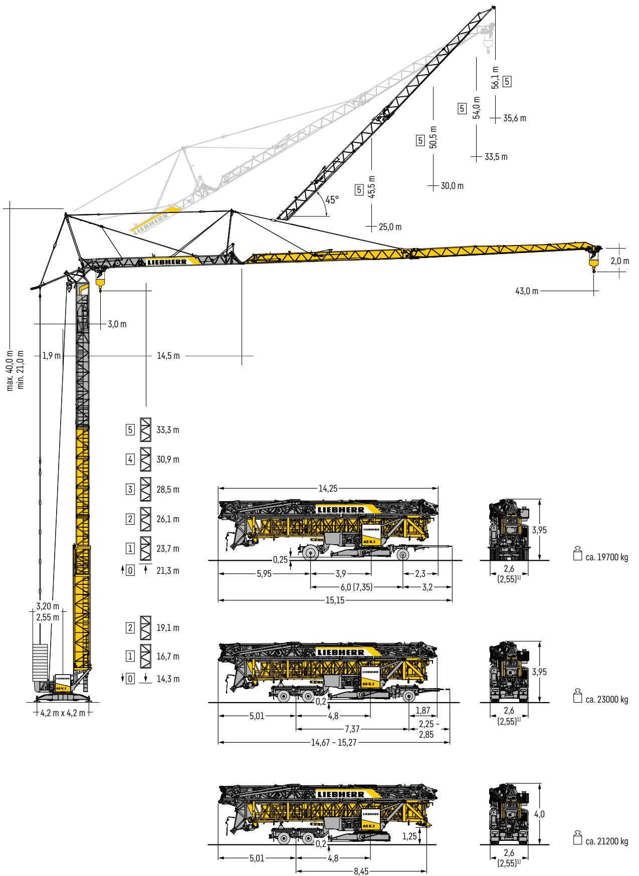
**Alle Maße in m** - All dimensions in m - Toutes les dimensions en m - Tutte le dimensioni in m - Todas las medidas en m - Todas as dimensões em m - Всё размеры в м
